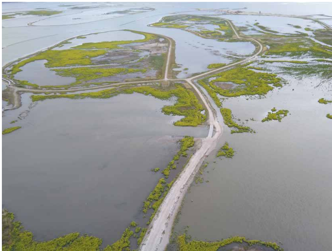
Marker Wadden vanuit de lucht: “watereilanden” als interventie om nieuwe moerasontwikkeling in verbinding met het meer mogelijk te maken (Beeld, 2022, Mennobart van Eerden)
